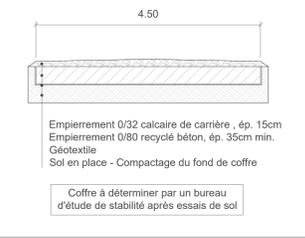
Tranchée du raccordement électrique - 2 systèmes de câbles
